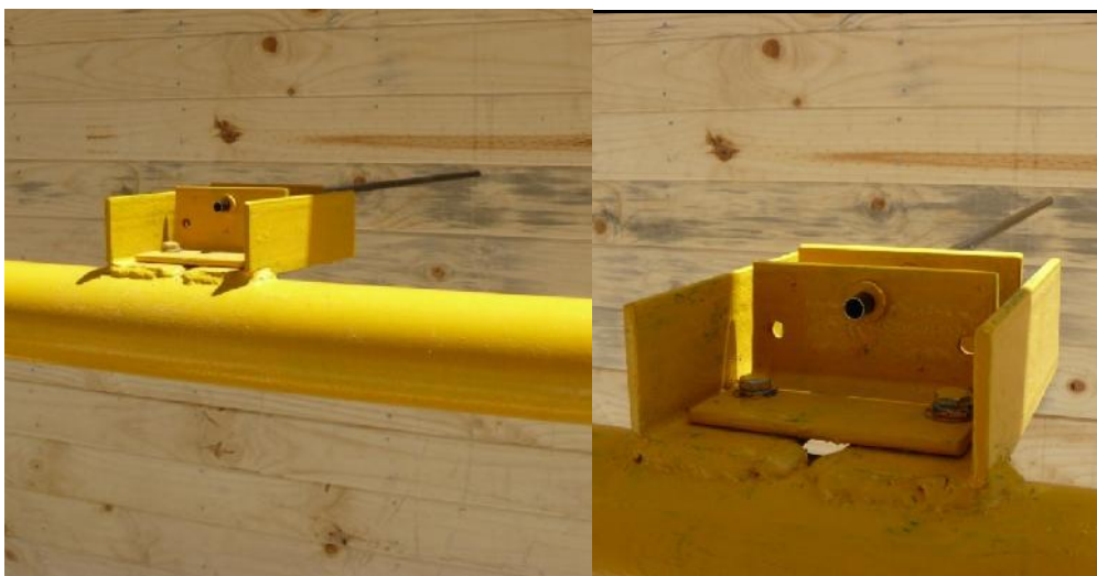
Figura N° 3: Foto del deflectómetro y detalle.
